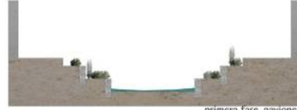
primera fase gaviones
